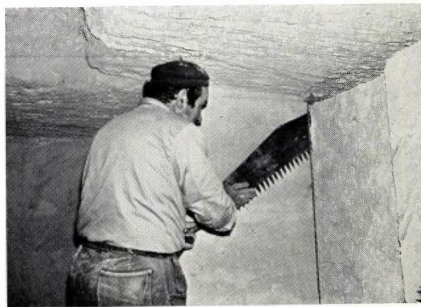
Foto 7. De breker begint met de „voar” tussen het „sjaap” en de muur. Hier zet hij voor het eerst de opzetzaag op zijn plaats om het eerste „voarsjtuk” los te zagen.
